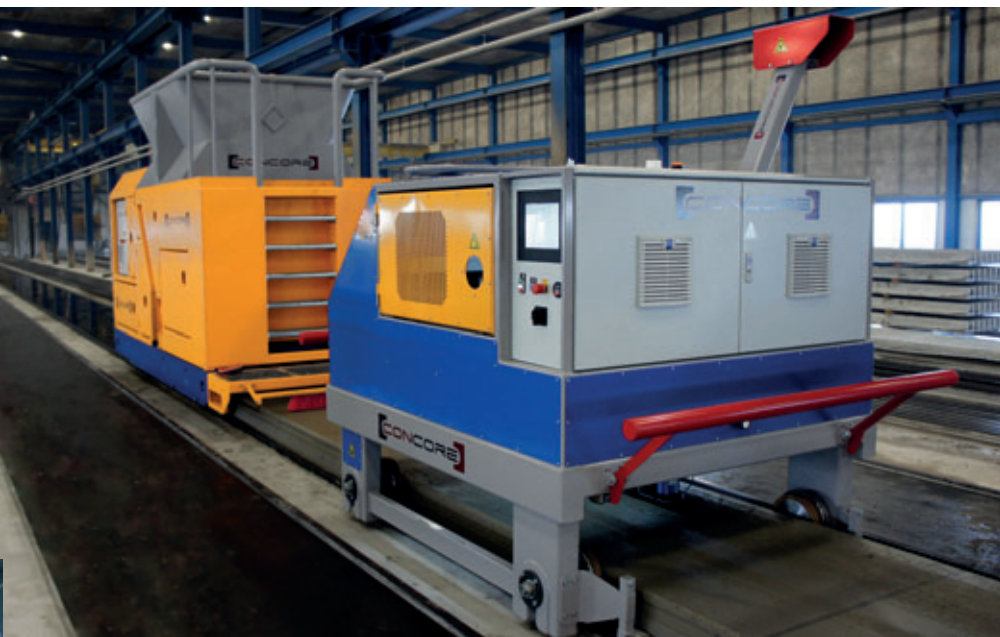
Fig. 3 : Une livraison récente de Concore à une usine de dalles alvéolées avec 6 bancs à Bisofloor, Pays-Bas. Concore a modifié l'extrudeuse pour répondre aux spécifications du client.
