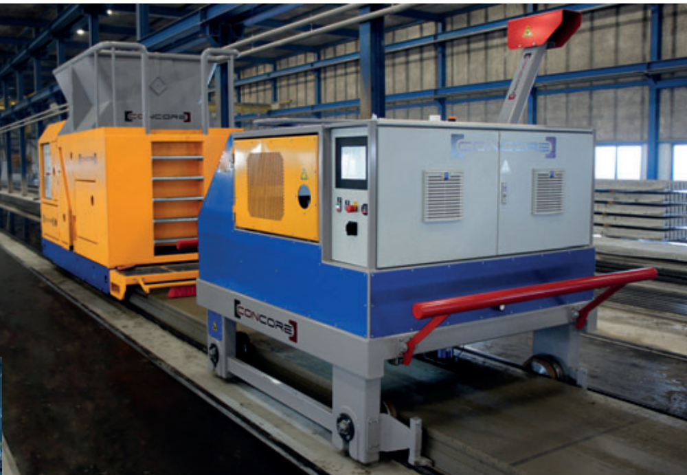
Fig. 3: Um fornecimento recente da Concore a uma fábrica de lajes alveolares protendidas com seis pistas em Bisofloor, na Holanda. A Concore alterou a extrusora para ir ao encontro das especificações do cliente.
